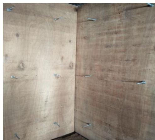
Fig. 1: (d) Plywood Specimen Mounting on Wall
