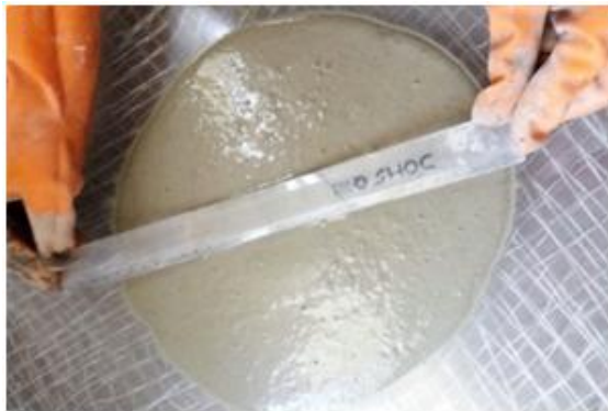
Fig. 1: Mini Slump Flow Test
