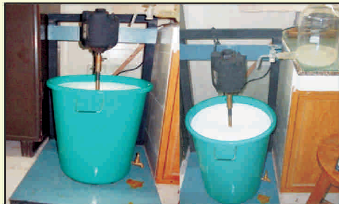
आकृति 1: सिलिका नैनो कणों के प्रयोगशाला स्तर पर निर्माण का ढांचा।
