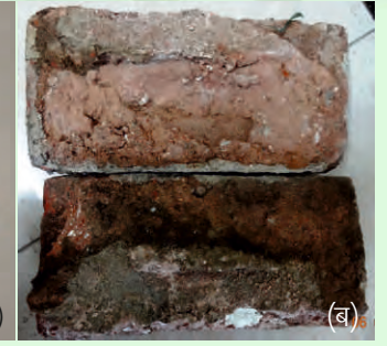
आकृति 2 (अ) सोलानी जलप्रणाल के मसाले तथा (ब) ईंटों के नमूने
