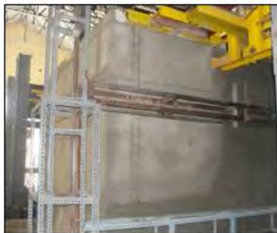
(d) Jacketing using plastic cement bag
