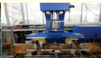
आकृति-6 (ए-डी): संरचनात्मक परीक्षण सैट-अप तथा बीमों का परीक्षण
