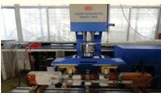
आकृति-6 (ए-डी): संरचनात्मक परीक्षण सैट-अप तथा बीमों का परीक्षण
