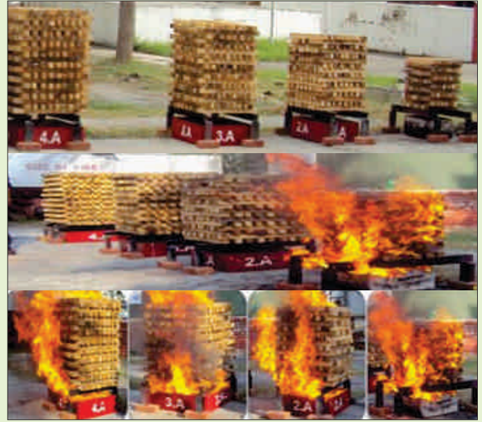
आकृति-1: वाटर मिस्ट प्रणाली की अग्नि शमन प्रभावशीलता पर आधारित संयोजनों के इष्टतमीकरण हेतु वुडन क्राइब क्लास “ए” अग्नि पर आईएस: 15683-2006 के अनुसार डिस्चार्ज क्लस्टर में सूक्ष्म आकार कणों पर तुलनात्मक मूल्यांकन करने के उद्देश्य से नयी सुविधा विकसित एवं स्थापित की गयी।
