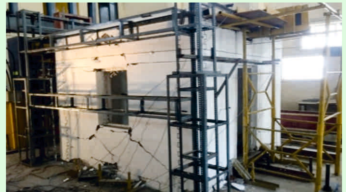
आकृति-3: भराव की स्थिति में रेट्रोफिटिड परिरुद्ध चिनाई भवन का क्षति स्वरूप (डैमेज पैटर्न)
