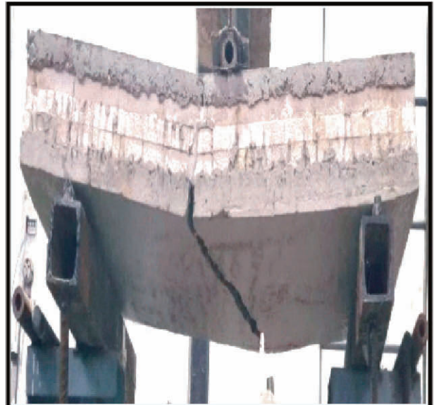
चित्र : 6- परीक्षण के दौरान पैनल पर क्रैक पैटर्न
