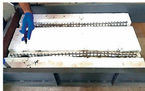
चित्र : 2- फॉर्मवर्क के साथ ईपीएस नमूना
